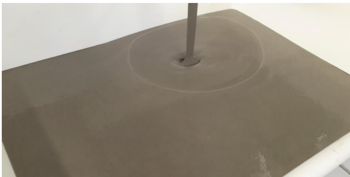
Photo d'une chape autonivelante réalisée avec le Pentaflow SA.2
