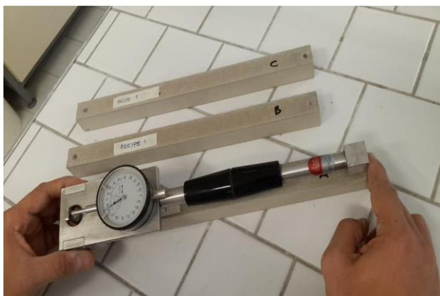
Action du **Pentamix EX 3** sur le retrait hydraulique dans un mortier standard Pentachem (dosage 0,5% sur le total)
